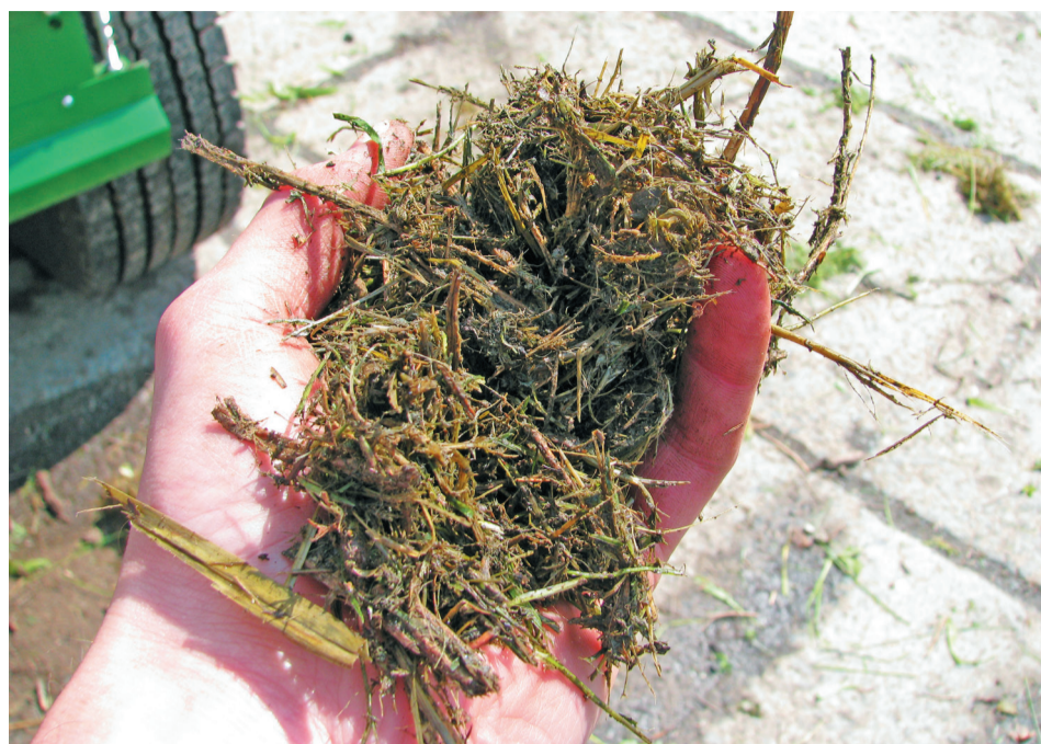
Materiál podrcený a promíchaný strojem ZAGO-ECOGREEN před natlačením do LDPE vaku
